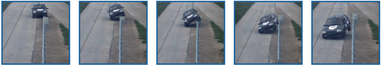
TT 2.1.80 Crash Test EASY-RAIL P2
